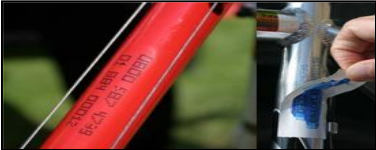
Markierung mittels chemischer Ätzung
