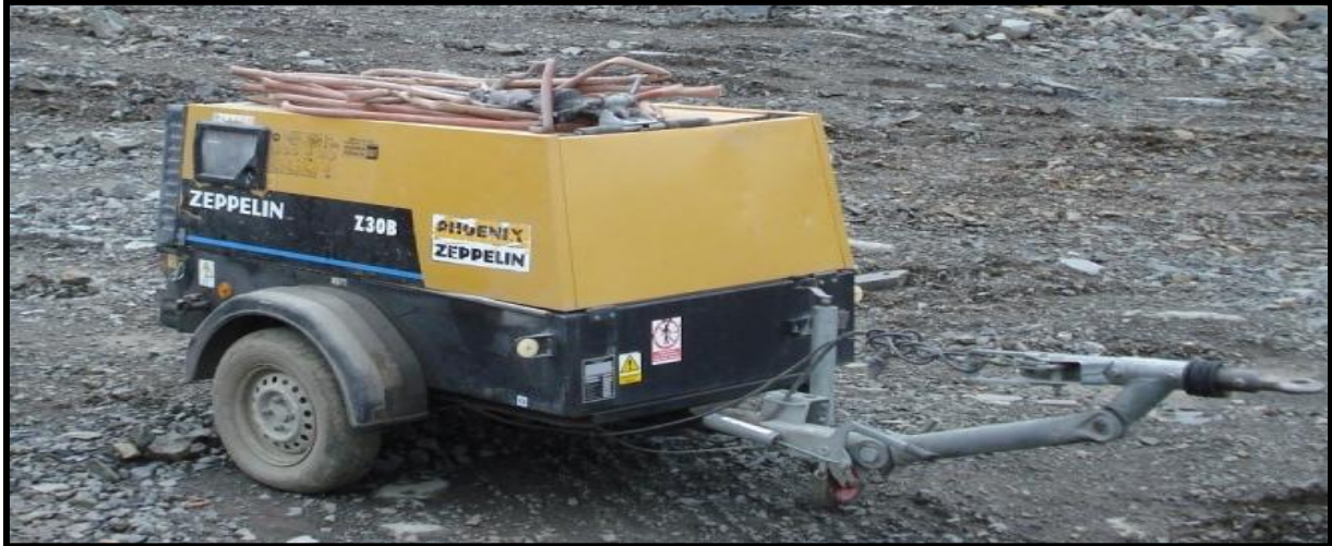
Kompressor in einem Steinbruch/ auf Baustellen
