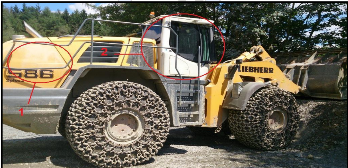
Mögliche Markierungsstellen an Baumaschinen am Beispiel eines Radladers
