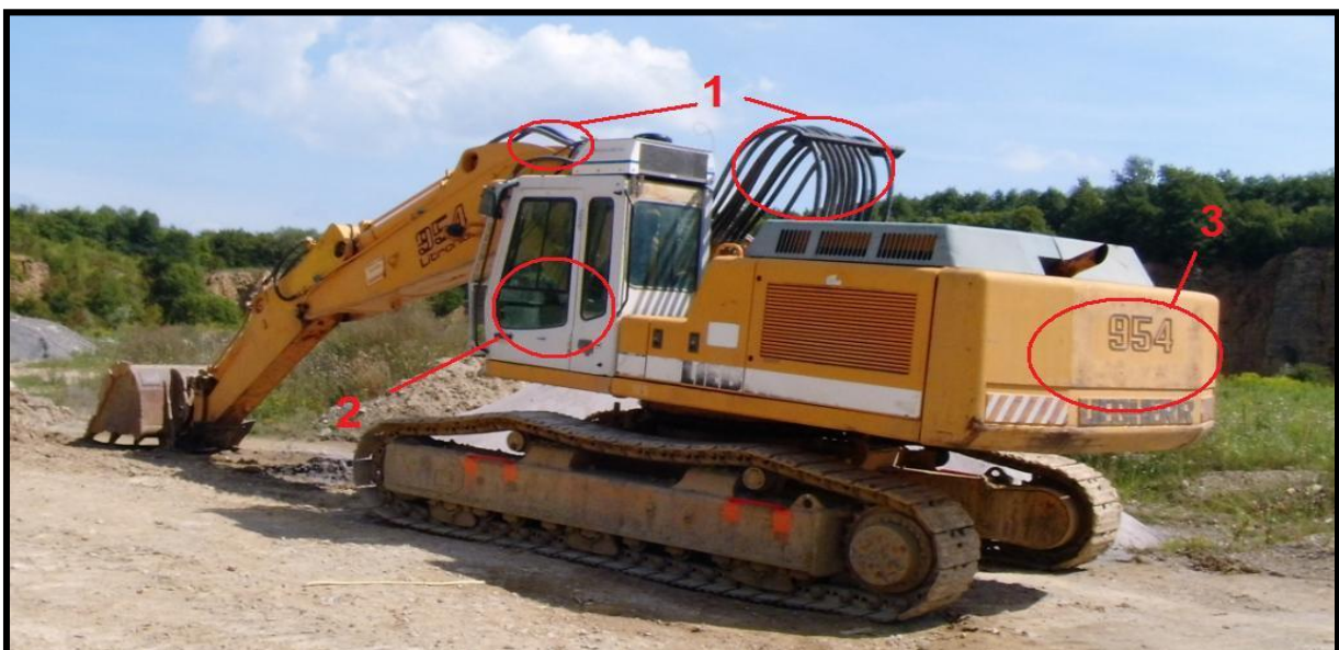
Mögliche Markierungsstellen an einem Bagger
