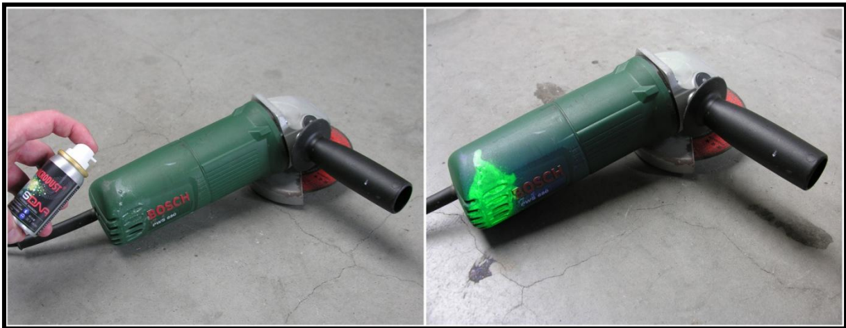
Werkzeugmarkierung mittels SDNA-Microdust-L
