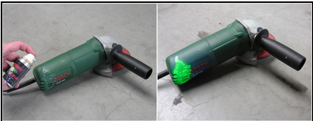
Markierung von Werkzeug mit künstlicher DNA
