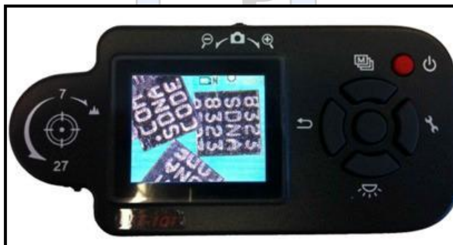
Auslesen der Microdots per Mikroskopkamera
