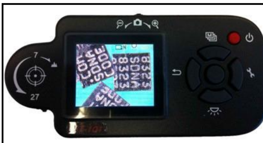
Auslesen der Microdots per Mikroskopkamera
