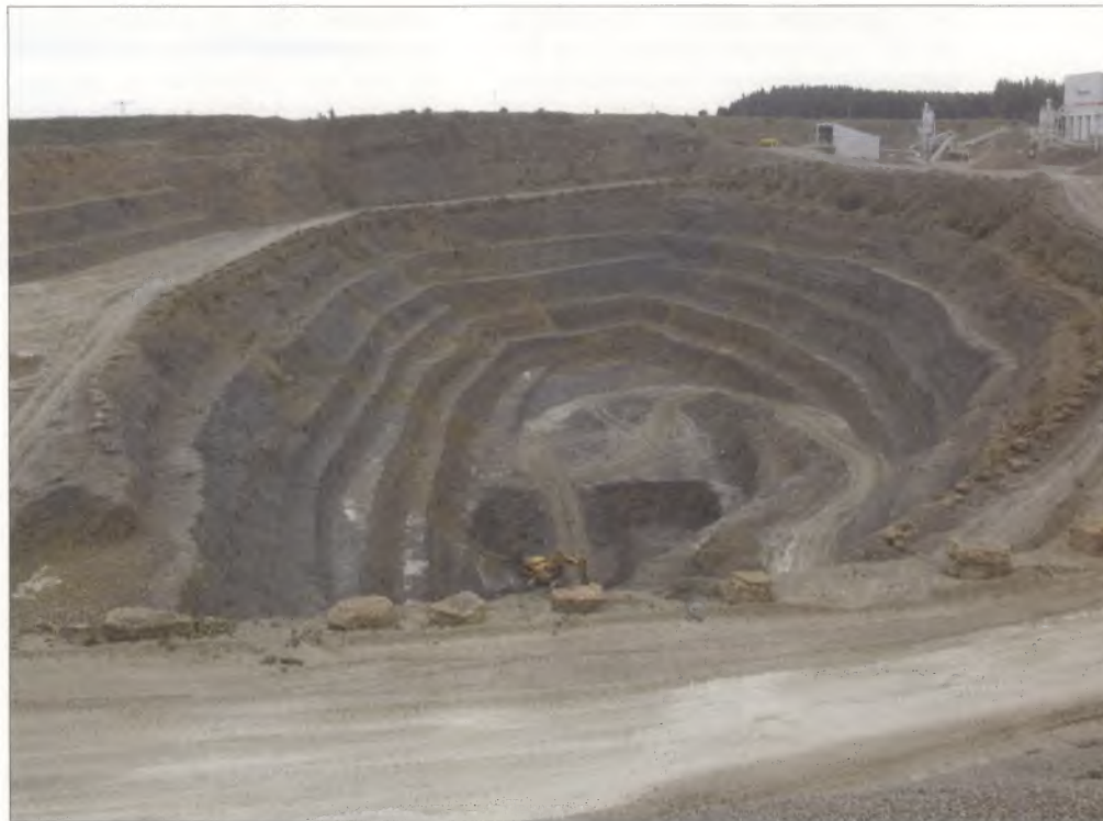
Typischer Kesselbruch auf engem Raum; für mobile Vorbrechsysteme ungeeignet. Dumpertransport mit langen Fahrwegen und großer Hubhöhe erforderlich.
